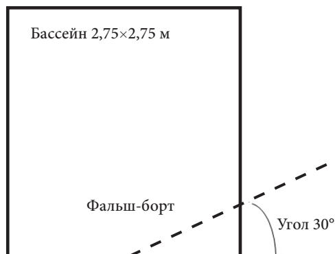
Рис. 3 / Fig. 3. Схема бассейна с фальш-бортом / A diagram of a pool with a raised board
