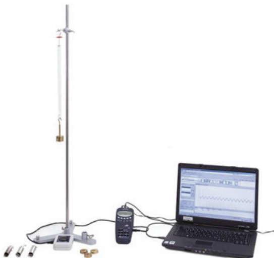
Рис. 6 / Fig. 6. Экспериментальная установка для определения коэффициента жёсткости / Experimental setup for determining the stiffness coefficient
