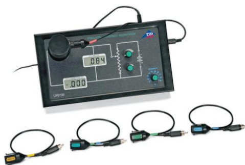
Рис. 4 / Fig. 4. Экспериментальная установка для определения работы выхода электронов из металлического катода / Experimental setup for determining the work function of electrons from a metal cathode
