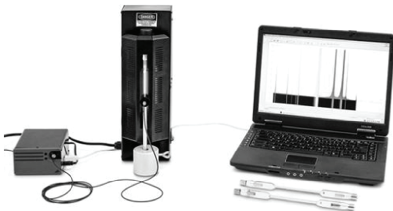
Рис. 2 / Fig. 2. Экспериментальная установка по изучению спектрального состава вещества / Experimental setup for studying the spectral composition of matter
